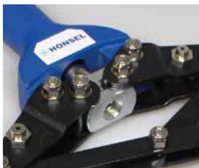
Wechselmundstücke im Werkzeug verschraubt.
