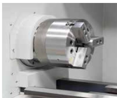
Hydraulik-Spannfutter Ø 260 mm serienmäßig
